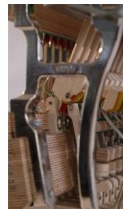
Abb.: 138 T verfügt über die klassische Steingraeber-Mechanik (oder die flügelgleiche SFM®-Mechanik auf Anfrage)
